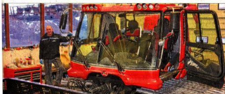
André Chomaz, chef de garage, intervient sur les dameuses Prinoth et Kassbohrer. Il assure toutes les inspections, vidanges, contrôles... Il y a un travail préventif l'été : toutes les machines sont démontées. L'hiver quotidien, il faut vérifier le serrage des accessoires, s'il n'y a pas de fuite. Il y a parfois des pannes :
